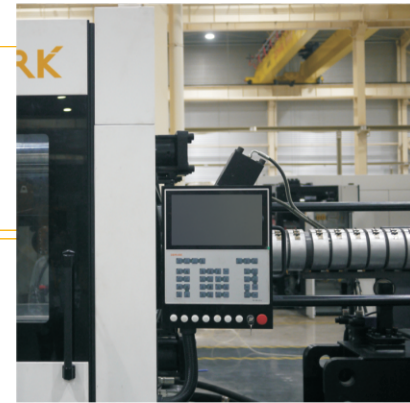
倍福控制系统 BECKHOFF control system
